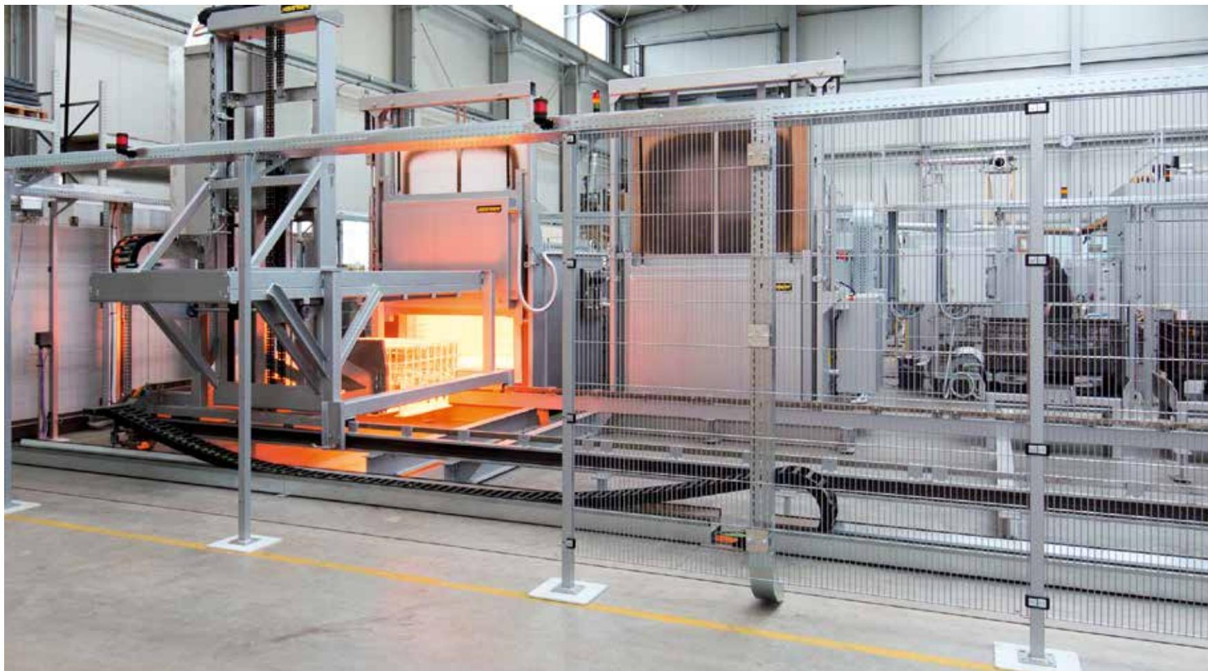
Auch Vergüteanlagen mit Kammeröfen und Manipulator sind modular erweiterbar. Foto: NABERTHERM
