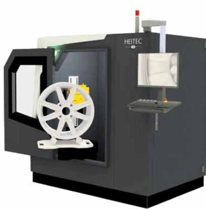
Die HeiDetect Live View ist die ideale Ergänzung zu vollautomatischen Röntgensystemen wie dem HeiDetect Wheel Robot. Sie rundet das Portfolio von Heitec für Gießereien ab.
